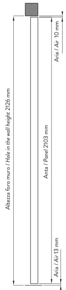
Anta spessore 58 mm con telaio in alluminio per cartongesso
